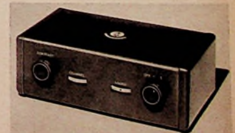
Band-III-Vorsatzgerät für ältere Fernsehgeräte, die nur für Band I ausgelegt sind. Der Vorsatz besitzt eigenen Netzteil (EMI)
