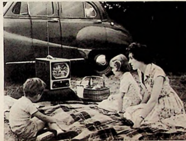
Die Sensation der Radio Show war dieser transportable Fernsehempfänger von Ekco mit 30-cm-Bildröhre, ausgelegt für Band I und III sowie für UKW-Rundfunk in Band II. Stromversorgung: Wechselstromnetz und 12-V-Batterie. Gewicht 12 kg, Preis rund 720 DM
